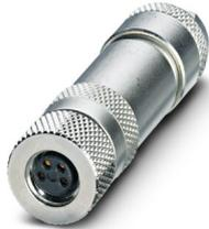
Steckverbinder, Universal, 4-polig, geschirmt, Buchse gerade M8, Kodierung: A, Schraubanschluss, Rändelmaterial: Messing, vernickelt, Leitungsaußendurchmesser 3,5 mm ... 5,5 mm
