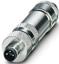
Steckverbinder, Universal, 3-polig, geschirmt, Stecker gerade M8, Kodierung: A, Schraubanschluss, Rändelmaterial: Messing, vernickelt, Leitungsaußendurchmesser 3,5 mm ... 5,5 mm
