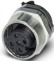
Gerätesteckverbinder Hinterwand, 5-polig, Buchse, gerade, M12-SPEEDCON, A-Kodierung, THR-Lötanschluss, dieser Artikel ist voraussichtlich ab 2026-Q2 nach RoHS II ohne Ausnahme 6c (Pb < 0,1 %) bleifrei, auf Anfrage ist eine bleifreie Alternative vorab möglich
