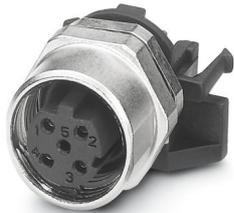
Gerätesteckverbinder Hinterwand, 4-polig, Buchse, gerade, M12-SPEEDCON, D-Kodierung, Wellenlöt, dieser Artikel ist voraussichtlich ab 2026-Q2 nach RoHS II ohne Ausnahme 6c (Pb < 0,1 %) bleifrei, auf Anfrage ist eine bleifreie Alternative vorab möglich
