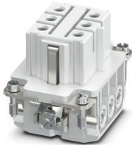
Kontakteinsatz, Polzahl: 6+PE, Baugröße: B6, Buchse, Schraubanschluss, 200 V, 16 A, 1,5 mm<sup>2</sup> ... 6 mm<sup>2</sup>, mit Kurzschlussfunktion
