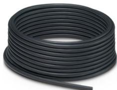
Stammleitung für Sensor-/Aktor-Boxen, ohne PE-Leiter, ungeschirmt, Material PUR/PVC, 18-polig, 16 x 0,34 mm<sup>2</sup> und 2 x 0,75 mm<sup>2</sup>, Länge: 50 m
