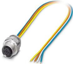
Gerätesteckverbinder Vorderwand, PROFINET CAT5 (IEC 11801:2002), 4-polig, Buchse, gerade, M12-SPEEDCON, D-Kodierung, auf freies Leitungsende, Einzellitzen, Kabellänge: 0,5 m, 0,34 mm<sup>2</sup>, TPE-Litze, vergossen, dieser Artikel ist voraussichtlich ab 2025-Q3 nach RoHS II ohne Ausnahme 6c (Pb < 0,1 %) bleifrei, auf Anfrage ist eine bleifreie Alternative vorab möglich
