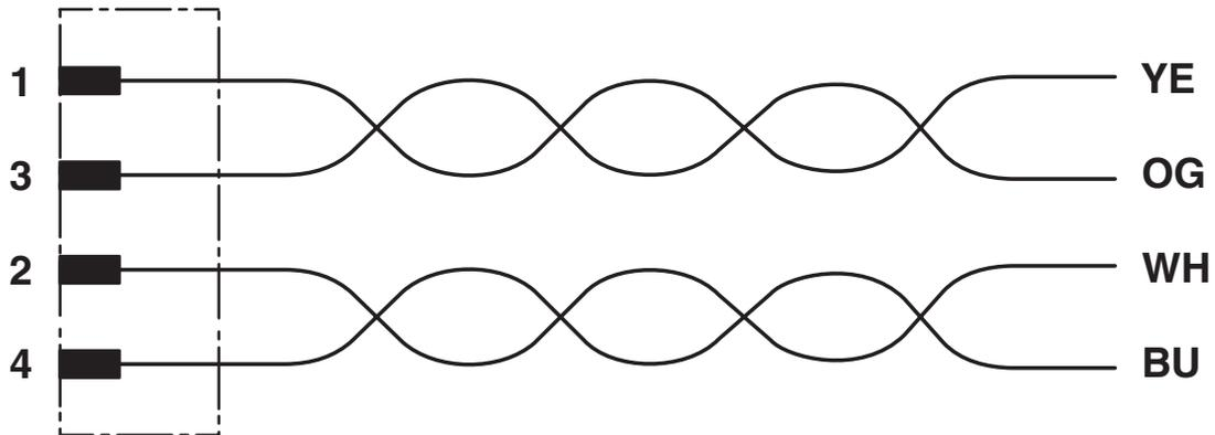
Kontaktbelegung der M12-Buchse
