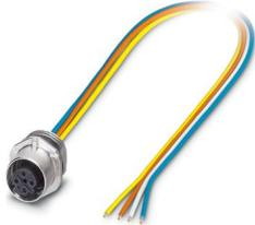
Gerätesteckverbinder Vorderwand, PROFINET CAT5 (IEC 11801:2002), 4-polig, Buchse, gerade, M12-SPEEDCON, D-Kodierung, auf freies Leitungsende, Einzellitzen, Kabellänge: 0,5 m, 0,34 mm<sup>2</sup>, TPE-Litze, vergossen, Artikel ist bleifrei nach RoHS II ohne Ausnahme 6c (Pb < 0,1 %)
