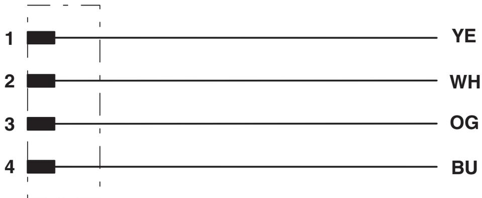
Kontaktbelegung der M12-Buchse
