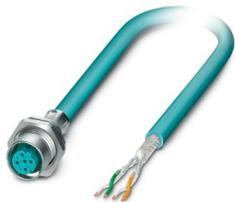
Gerätesteckverbinder Hinterwand, Ethernet CAT5 (100 MBit/s), Ethernet, 4-polig, PUR, wasserblau RAL 5021, geschirmt, Buchse, gerade, M12, D-Kodierung, auf freies Leitungsende, Kabelanschluss, Kabellänge: 1 m, Ethernet flexibel CAT5, 2-paarig, dieser Artikel ist voraussichtlich ab 2027-Q1 nach RoHS II ohne Ausnahme 6c (Pb < 0,1 %) bleifrei, auf Anfrage ist eine bleifreie Alternative vorab möglich
