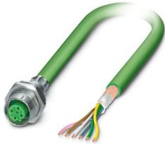
Gerätesteckverbinder Hinterwand, INTERBUS (16 MBit/s), 5-polig, PUR halogenfrei, grün RAL 6017, geschirmt, Buchse, gerade, M12-SPEEDCON, B-Kodierung, auf freies Leitungsende, Kabelanschluss, Kabellänge: 2 m, INTERBUS, dieser Artikel ist voraussichtlich ab 2026-Q2 nach RoHS II ohne Ausnahme 6c (Pb < 0,1 %) bleifrei, auf Anfrage ist eine bleifreie Alternative vorab möglich
