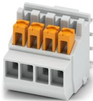
Leiterplattenklemme, Nennstrom: 8 A, Bemessungsspannung (III/2): 160 V, Nennquerschnitt: 1,5 mm<sup>2</sup>, Anzahl der Reihen: 1, Polzahl pro Reihe: 4, Artikelfamilie: FKDSO 1,5/..-R, Anschlussart: Push-in-Federanschluss, Montage: Wellenlöten, Anschlussrichtung Leiter/Platine: 0 °, Farbe: lichtgrau, Anzahl der Lötpins pro Potenzial: 1
