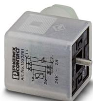
Ventilstecker, Universal, 3-polig, Ventilstecker A, Schraubanschluss, Kabelverschraubung Pg9, Leitungsaußendurchmesser 6 mm ... 8 mm
