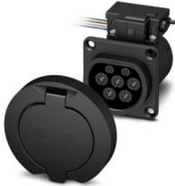
CHARX connect modular, Typ 2, Infrastruktur-Ladedose, 32 A , 480 V AC, Basic, Set, ohne Einzeladern, Verriegelungsaktuator: 12 V, 4-polig, eckig, Rückwandmontage, M5-Gewinde, Gehäuse: schwarz, mit rundem Schutzdeckel, zum Laden mit Wechselstrom (AC) von Elektrofahrzeugen (EV), PHOENIX CONTACT-Logo, IEC 62196-2
