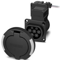
CHARX connect modular, Typ 2, Infrastruktur-Ladedose, 32 A , 480 V AC, Premium, Set, ohne Einzeladern, Verriegelungsaktuator: 12 V, 3-polig, eckig, Rückwandmontage, M5-Gewinde, Gehäuse: schwarz, mit rundem Schutzdeckel, mit Temperatursensorik, mit LED (gemeinsamer Kathodenanschluss), zum Laden mit Wechselstrom (AC) von Elektrofahrzeugen (EV), PHOENIX CONTACT-Logo, IEC 62196-2
