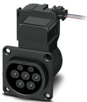
CHARX connect modular, Typ 2, Infrastruktur-Ladedose, 32 A , 480 V AC, Premium, ohne Einzeladern, Verriegelungsaktuator: 12 V, 3-polig, eckig, Rückwandmontage, M5-Gewinde, Gehäuse: schwarz, mit Temperatursensorik, mit LED (gemeinsamer Kathodenanschluss), zum Laden mit Wechselstrom (AC) von Elektrofahrzeugen (EV), PHOENIX CONTACT-Logo, IEC 61851-1, IEC 62196-2
