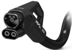
CHARX connect professional, CCS Typ 2, HPC-DC-Ladeleitung, bis zu 500 A im Boost Mode, 375 A dauerhaft, 1000 V DC, mit Fahrzeug-Ladestecker und offenem Leitungsende, Kabel: 6,5 m, schwarz, gerade, unterstützt Vier-Leiter-Messtechnik, mit analoger Temperatursensorik, mit austauschbarem Steckgesichtrahmen, mit austauschbaren DC-Leistungskontakten, mit angeschlossenem PP-Kontakt, PHOENIX CONTACT-Logo, in Anlehnung an IEC 62196-3, zum Laden mit Gleichstrom (DC) von Elektrofahrzeugen (EV)
