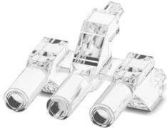
Mehrfachlichtleiter, passiv, starr, Zylinderkopf, Abstrahlfläche: planar, Anzahl der Anzeigen: 3, (3 Reihen, 1 Spalte), Rastermaß: 5,08 mm, ESD-Schutz: <12 kV, nutzbar für Gehäusefamilie BC (Bearbeitung des Gehäuses erforderlich)
