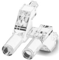
Mehrfachlichtleiter, passiv, starr, Zylinderkopf, Abstrahlfläche: planar, Anzahl der Anzeigen: 2, (2 Reihen, 1 Spalte), Rastermaß: 5,08 mm, ESD-Schutz: <12 kV, nutzbar für Gehäusefamilie BC (Bearbeitung des Gehäuses erforderlich)
