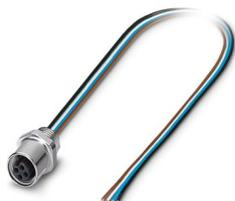
Gerätesteckverbinder Vorderwand, 4-polig, Buchse, gerade, M5, A-Kodierung, Einzellitzen, Kabellänge: 0,5 m, 0,14 mm<sup>2</sup>, TPE-Litze
