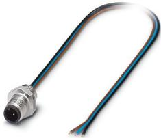
Gerätesteckverbinder Vorderwand, 3-polig, Stift, gerade, M5, A-Kodierung, Einzellitzen, Kabellänge: 0,5 m, 0,14 mm<sup>2</sup>, TPE-Litze
