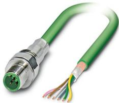
Gerätesteckverbinder Vorderwand, INTERBUS (16 MBit/s), 5-polig, PUR halogenfrei, grün RAL 6017, geschirmt, Stift, gerade, M12, B-Kodierung, auf freies Leitungsende, Kabelanschluss, Kabellänge: 1 m, INTERBUS, dieser Artikel ist voraussichtlich ab 2025-Q4 nach RoHS II ohne Ausnahme 6c (Pb < 0,1 %) bleifrei, auf Anfrage ist eine bleifreie Alternative vorab möglich
