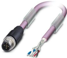
Bussystem-Kabel, CANopen®, DeviceNet™, 5-polig, PUR halogenfrei, violett RAL 4001, geschirmt, Stecker gerade M12, Kodierung: A, auf freies Leitungsende, Kabellänge: 0,3 m
