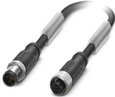
Sensor-/Aktor-Kabel, 5-polig, PUR halogenfrei, schwarzgrau RAL 7021, geschirmt (Advanced Shielding Technology), Stecker gerade M12, Kodierung: A, auf Buchse gerade M12, Kodierung: A, Kabellänge: 10 m
