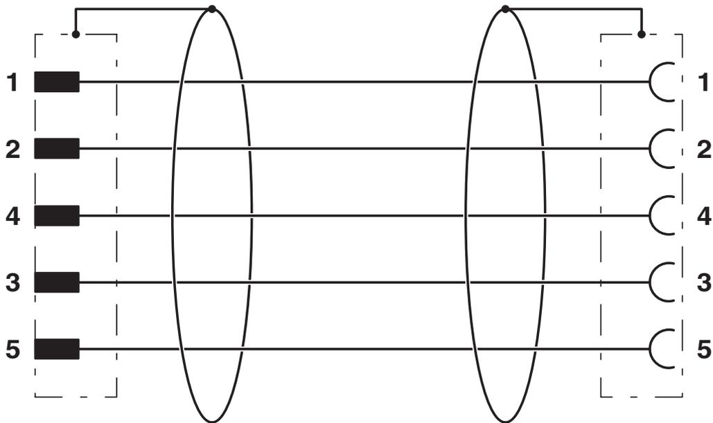
Kontaktbelegung des M12-Stecker und der M12-Buchse
