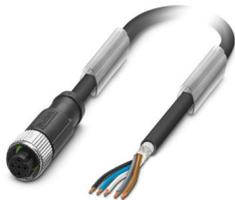
Sensor-/Aktor-Kabel, 5-polig, PUR halogenfrei, schwarzgrau RAL 7021, geschirmt (Advanced Shielding Technology), freies Leitungsende, auf Buchse gerade M12, Kodierung: A, Kabellänge: 20 m
