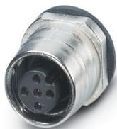
Gerätesteckverbinder Hinterwand, 5-polig, Buchse, gerade, M12-SPEEDCON, A-Kodierung, THR-Lötanschluss, Artikel ist bleifrei nach RoHS II ohne Ausnahme 6c (Pb < 0,1 %)
