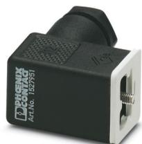
Ventilstecker, 3-polig, Ventilstecker C (8 mm), Schraubanschluss, Kabelverschraubung Pg9, Leitungsaußendurchmesser 6 mm ... 8 mm
