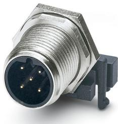
Gerätesteckverbinder Hinterwand, 5-polig, Stift, gewinkelt, M12, B-Kodierung, Wellenlöten
