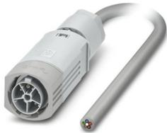
Verbindungsleitung/ Push-Lock-Anschluss, Polzahl: 4+PE, Stift, 450 V, 16 A, PA, lichtgrau, Kodierung: P, 2,5 mm<sup>2</sup>, Leitungslänge: 1 m, Stift gerade, auf freies Leitungsende
