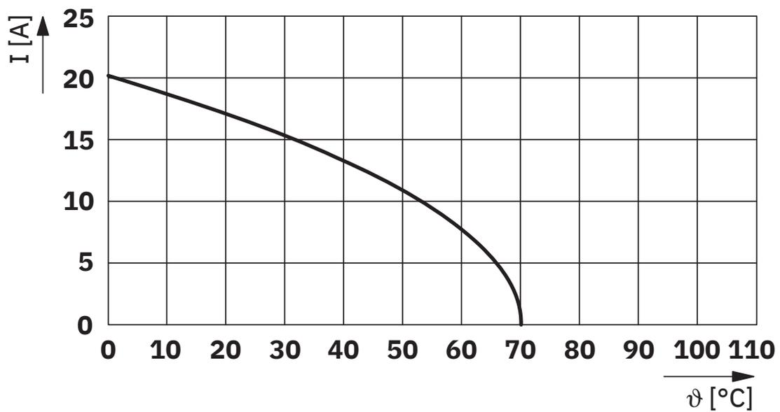
Derating-Diagramm für Kabel, bewegliche Verlegung
