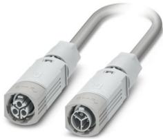
Verbindungsleitung/ Push-Lock-Anschluss, Polzahl: 2+PE, Buchse/Stift, 450 V, 16 A, PA, lichtgrau, Kodierung: P, 2,5 mm<sup>2</sup>, Leitungslänge: 0,5 m, Stift gerade, auf Buchse gerade
