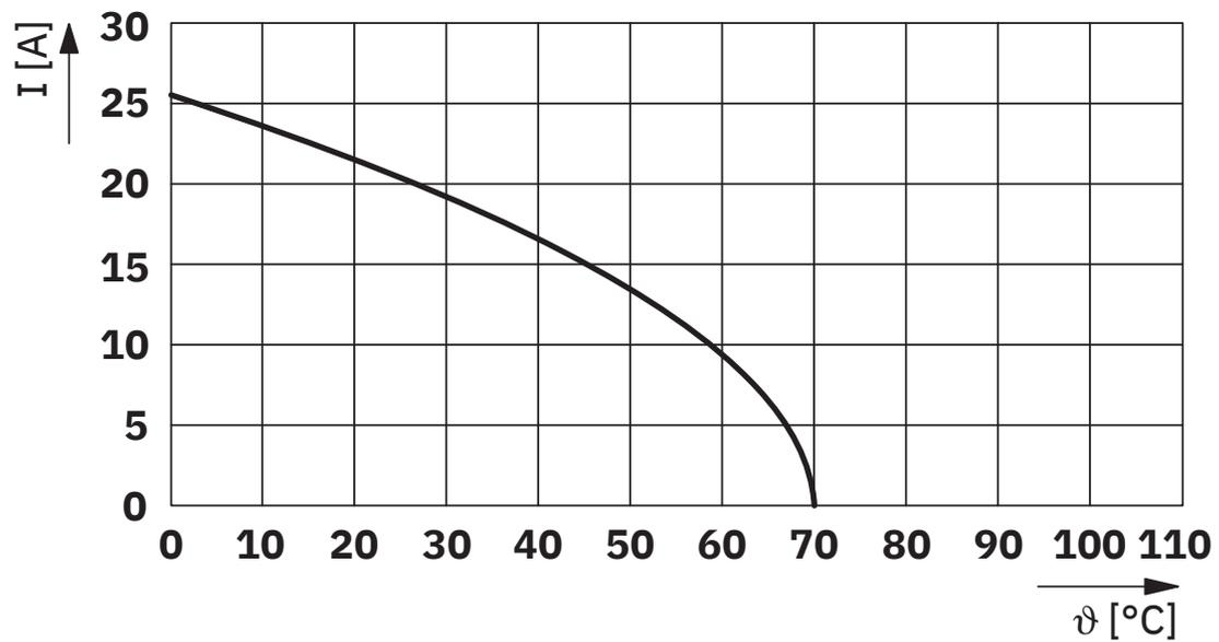
Derating-Diagramm für Kabel, bewegliche Verlegung
