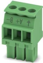
Leiterplattenstecker, Nennquerschnitt: 1,5 mm<sup>2</sup>, Farbe: grün, Nennstrom: 8 A, Bemessungsspannung (III/2): 160 V, Kontaktoberfläche: Sn, Kontaktart: Buchse, Anzahl der Reihen: 1, Polzahl: 3, Artikelfamilie: MCVW 1,5/..-ST, Rastermaß: 3,5 mm, Anschlussart: Schraubanschluss mit Zughülse, Schraubenangriffsform: L Längsschlitz, Anschlussrichtung Leiter/Platine: -90 °, Stecksystem: COMBICON MC 1,5, Verriegelung: ohne, Befestigungsart: ohne, Verpackungsart: verpackt im Karton
