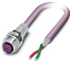
Gerätesteckverbinder Vorderwand, 2-polig, PUR halogenfrei, violett RAL 4001, geschirmt, Buchse, gerade, M12, B-Kodierung, auf freies Leitungsende, Kabelanschluss, Kabellänge: 1 m, 0,22 mm<sup>2</sup>, PROFIBUS, dieser Artikel ist voraussichtlich ab 2026-Q2 nach RoHS II ohne Ausnahme 6c (Pb < 0,1 %) bleifrei, auf Anfrage ist eine bleifreie Alternative vorab möglich
