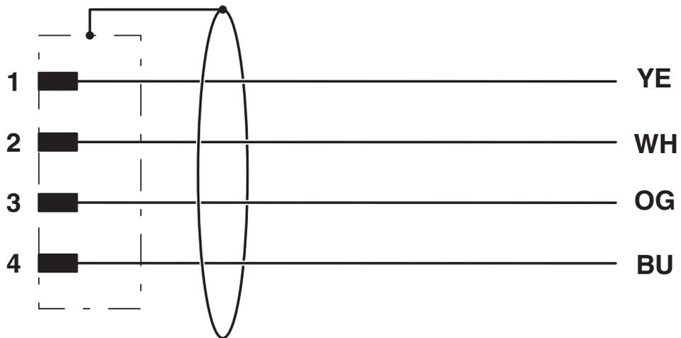
Kontaktbelegung des M12-Steckers
