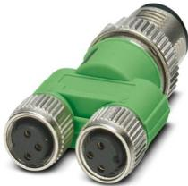
Y-Verteiler, 4-polig, Stecker gerade M12 SPEEDCON, Kodierung: A, auf Buchse gerade M8, Kodierung: A und Buchse gerade M8, Kodierung: A
