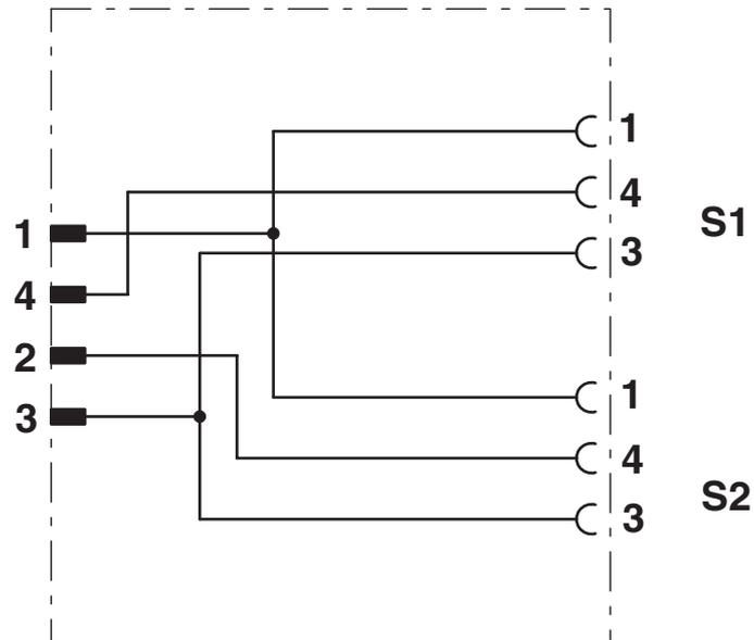
Kontaktbelegung des M12/M8 Y-Verteilers
