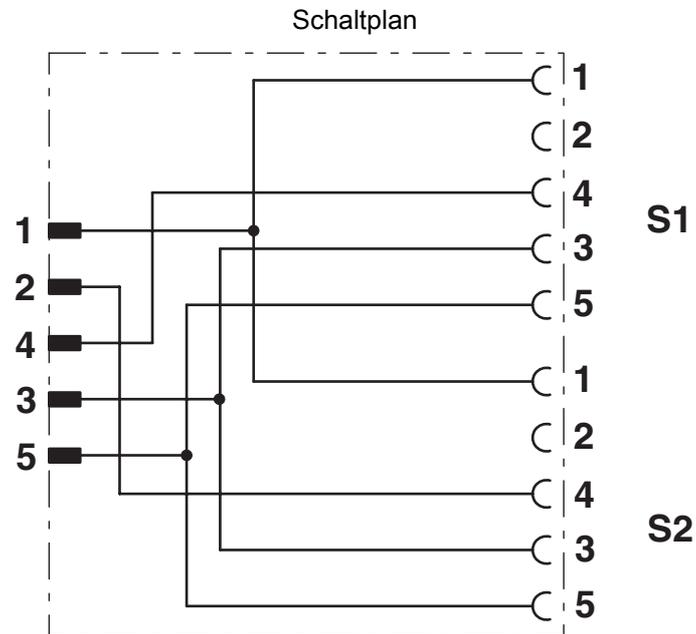
Kontaktbelegung des M12-Y-Verteilers
