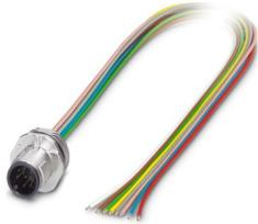
Gerätesteckverbinder Vorderwand, Universal, 8-polig, Stift, gerade, M12-SPEEDCON, A-Kodierung, auf freies Leitungsende, Einzellitzen, Kabellänge: 0,5 m, 0,25 mm<sup>2</sup>, TPE-Litze, vergossen, dieser Artikel ist voraussichtlich ab 2025-Q4 nach RoHS II ohne Ausnahme 6c (Pb < 0,1 %) bleifrei, auf Anfrage ist eine bleifreie Alternative vorab möglich
