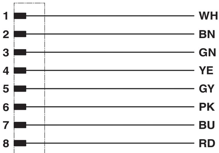
Kontaktbelegung des M12-Steckers
