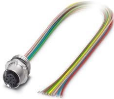
Gerätesteckverbinder Vorderwand, Universal, 8-polig, Buchse, gerade, M12-SPEEDCON, A-Kodierung, auf freies Leitungsende, Einzellitzen, Kabellänge: 0,5 m, 0,25 mm<sup>2</sup>, TPE-Litze, vergossen, dieser Artikel ist voraussichtlich ab 2025-Q4 nach RoHS II ohne Ausnahme 6c (Pb < 0,1 %) bleifrei, auf Anfrage ist eine bleifreie Alternative vorab möglich
