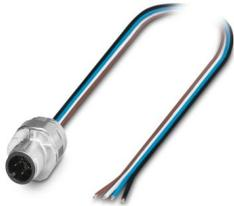
Gerätesteckverbinder Vorderwand, Universal, 4-polig, Stift, gerade, M12-SPEEDCON, A-Kodierung, auf freies Leitungsende, Einzellitzen, Kabellänge: 0,5 m, 0,34 mm<sup>2</sup>, TPE-Litze, vergossen, dieser Artikel ist voraussichtlich ab 2025-Q3 nach RoHS II ohne Ausnahme 6c (Pb < 0,1 %) bleifrei, auf Anfrage ist eine bleifreie Alternative vorab möglich
