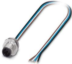
Gerätesteckverbinder Vorderwand, Universal, 4-polig, Stift, gerade, M12-SPEEDCON, A-Kodierung, auf freies Leitungsende, Einzellitzen, Kabellänge: 0,5 m, 0,34 mm<sup>2</sup>, TPE-Litze, vergossen
