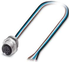
Gerätesteckverbinder Vorderwand, Universal, 4-polig, Buchse, gerade, M12, A-Kodierung, auf freies Leitungsende, Einzellitzen, Kabellänge: 0,5 m, 0,34 mm<sup>2</sup>, TPE-Litze, vergossen
