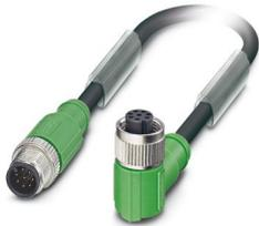
Sensor-/Aktor-Kabel, 8-polig, PUR halogenfrei, schwarzgrau RAL 7021, geschirmt, Stecker gerade M12, Kodierung: A, auf Buchse gewinkelt M12, Kodierung: A, Kabellänge: 3 m
