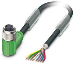
Sensor-/Aktor-Kabel, 8-polig, PUR halogenfrei, schwarzgrau RAL 7021, geschirmt, freies Leitungsende, auf Buchse gewinkelt M12, Kodierung: A, Kabellänge: 5 m
