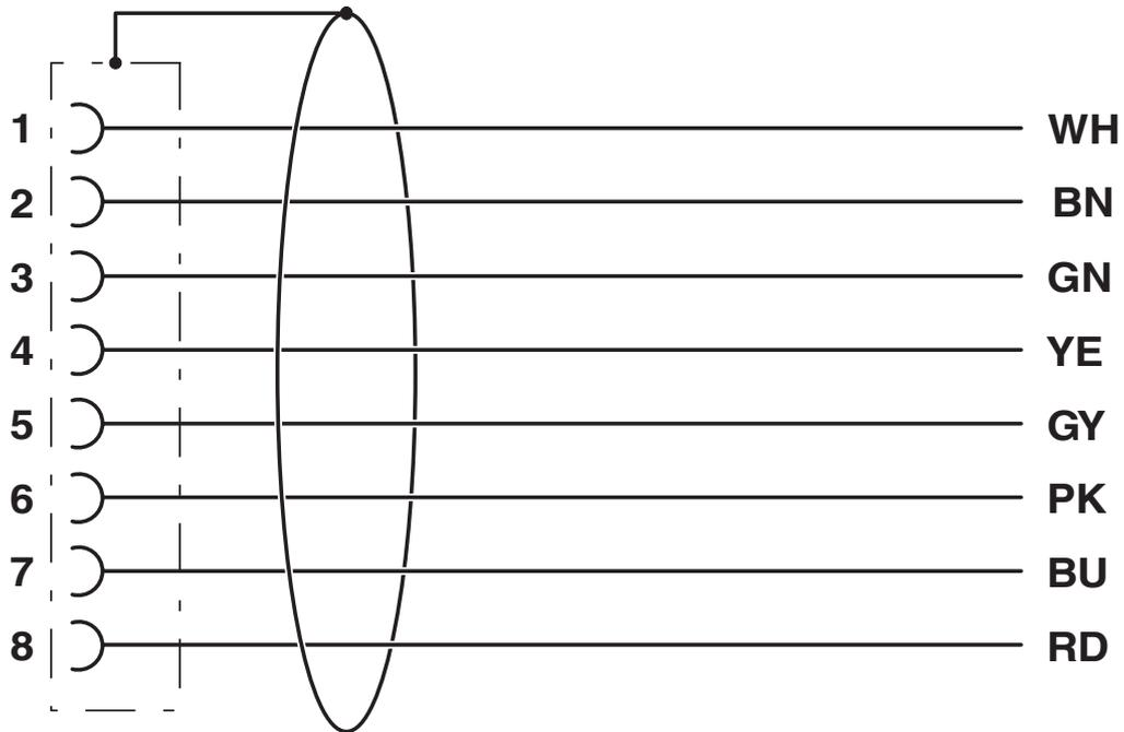
Kontaktbelegung der M12-Buchse
