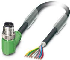
Sensor-/Aktor-Kabel, 8-polig, PUR halogenfrei, schwarzgrau RAL 7021, geschirmt, Stecker gewinkelt M12, Kodierung: A, auf freies Leitungsende, Kabellänge: 10 m
