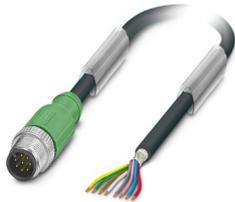
Sensor-/Aktor-Kabel, 8-polig, PUR halogenfrei, schwarzgrau RAL 7021, geschirmt, Stecker gerade M12, Kodierung: A, auf freies Leitungsende, Kabellänge: 1,5 m
