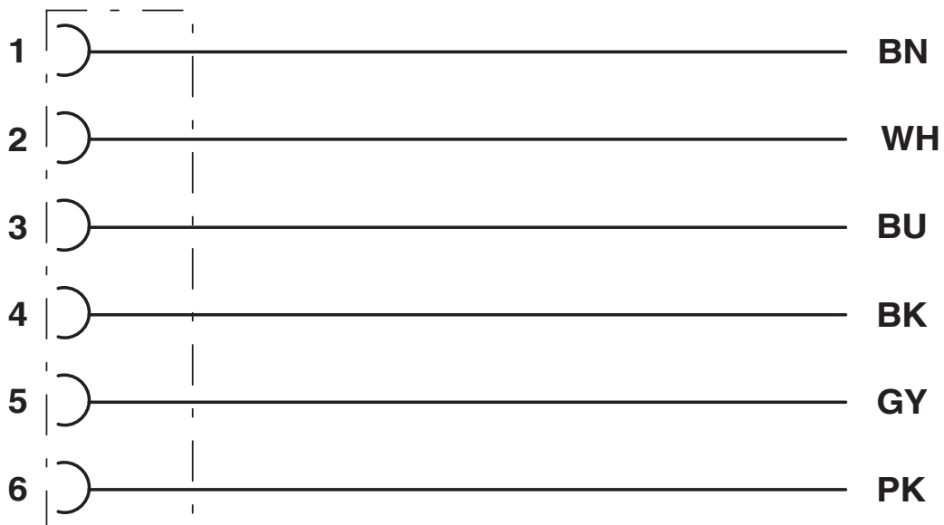
Kontaktbelegung der M8-Buchse
