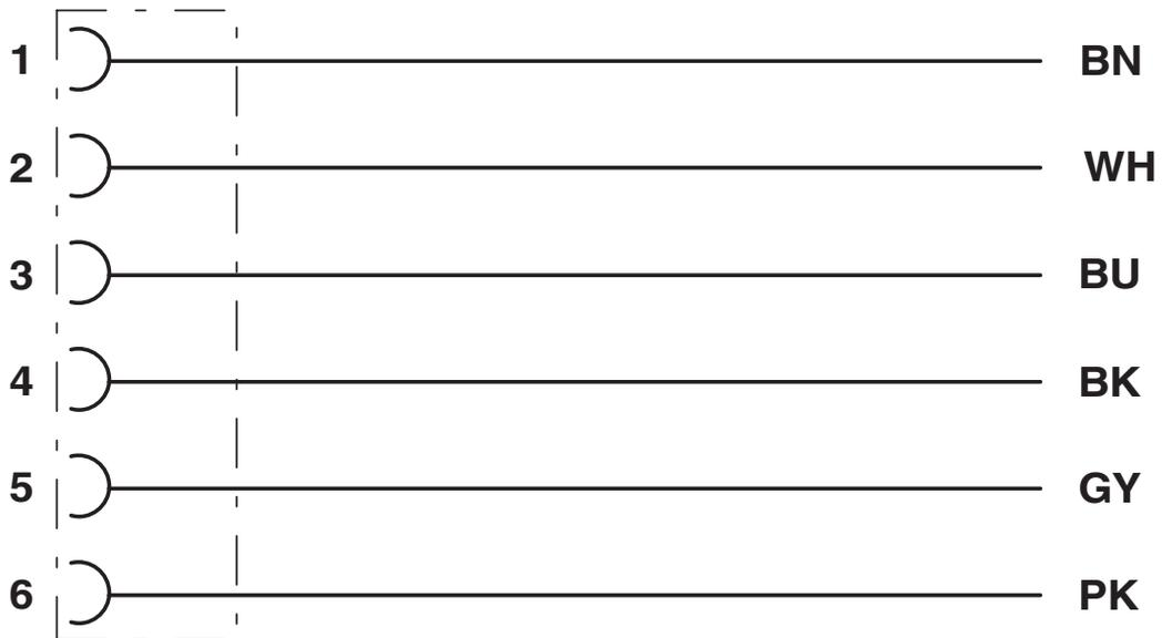
Kontaktbelegung der M8-Buchse
