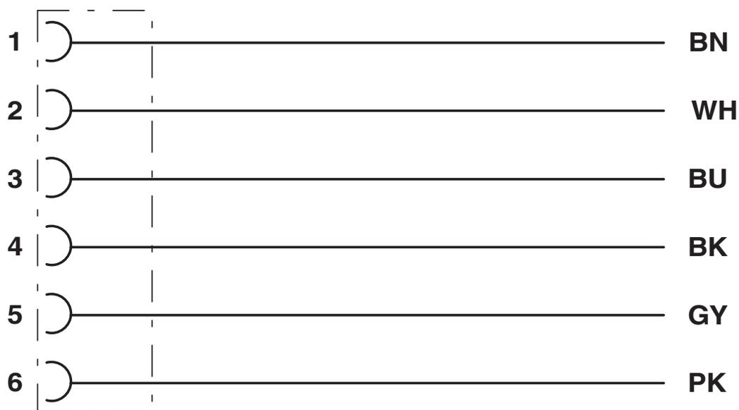
Kontaktbelegung der M8-Buchse
