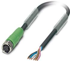
Sensor-/Aktor-Kabel, 6-polig, PUR halogenfrei, schwarzgrau RAL 7021, freies Leitungsende, auf Buchse gerade M8, Kodierung: A, Kabellänge: 10 m
