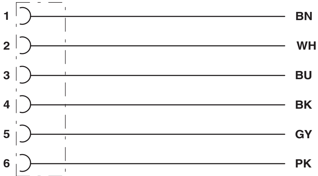
Kontaktbelegung der M8-Buchse
