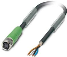
Sensor-/Aktor-Kabel, 4-polig, PUR halogenfrei, schwarzgrau RAL 7021, geschirmt, freies Leitungsende, auf Buchse gerade M8, Kodierung: A, Kabellänge: 10 m
