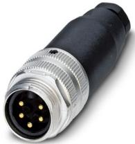
Steckverbinder, Universal, 5-polig, Stecker gerade 7/8"-16UNF, Kodierung: A, Schraubanschluss, Rändelmaterial: Zinkdruckguss, vernickelt, Kabelverschraubung Pg9, Leitungsaußendurchmesser 6 mm ... 8 mm, Kontakt 3 voreilend
