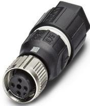
Steckverbinder, Universal, 4-polig, Buchse gerade M12 SPEEDCON, Kodierung: A, Schneidklemmanschluss, Rändelmaterial: Zinkdruckguss, vernickelt, Leitungsaußendurchmesser 4 mm ... 8 mm
